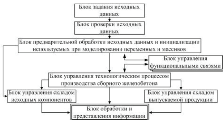
Рисунок 2. Общая структура системы оперативного управления технологическим процессом производства сборного железобетона
