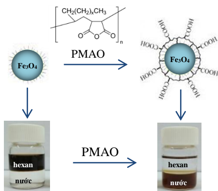
Hình 4: Minh họa quá trình chuyển pha hệ hạt nano Fe 3 O 4 10,2 nm bằng PMAO
