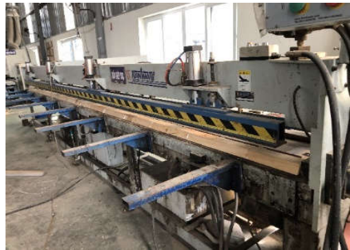
Hình 10. Ghép dài phiê hình thang trên máy ghép dọc
