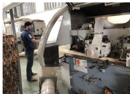
Hình 5. Bào nhẵn phôi hình thang trên máy bào 4 mặt
