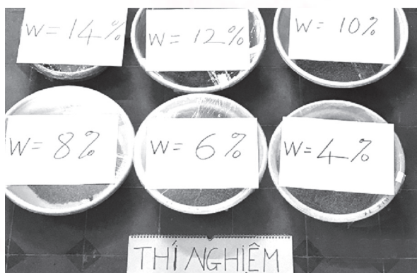
Mẫu xỉ được thực hiện với nhiều thí nghiệm khác nhau. Trong ảnh: Công đoạn thí nghiệm đảm bảo tiêu chuẩn của xỉ FHS.
