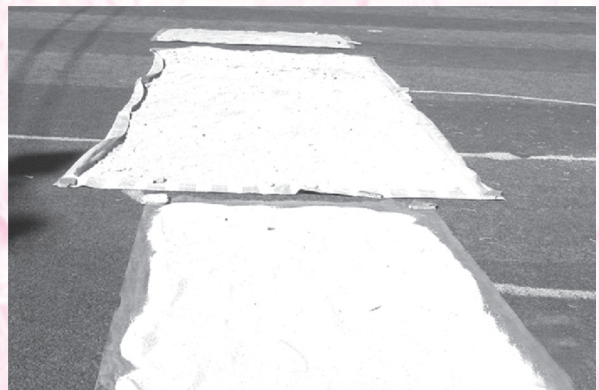
Mẫu xỉ được phơi khô hoàn toàn, sau đó bảo quản cách ẩm tại phòng thí nghiệm.
