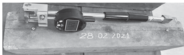
Hình 2.2: Mẫu đo co ngót bê tông đã chế tạo hoàn thành
