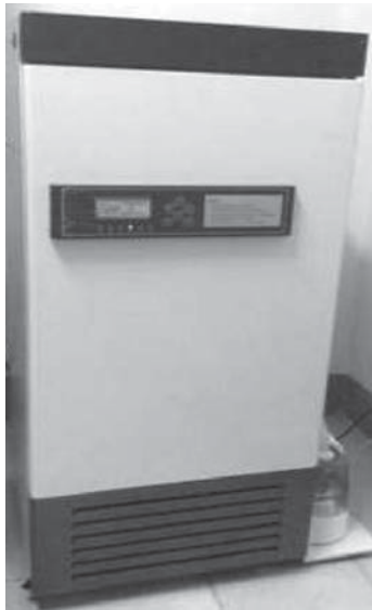
Hình 2.5: Tủ điều chỉnh nhiệt độ
