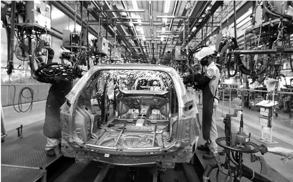
Dây chuyền lắp ráp ô tô du lịch tại nhà máy của Công ty cổ phần Ô tô Trường Hải trong Khu kinh tế mở Chu Lai, huyện Núi Thành, tỉnh Quảng Nam
