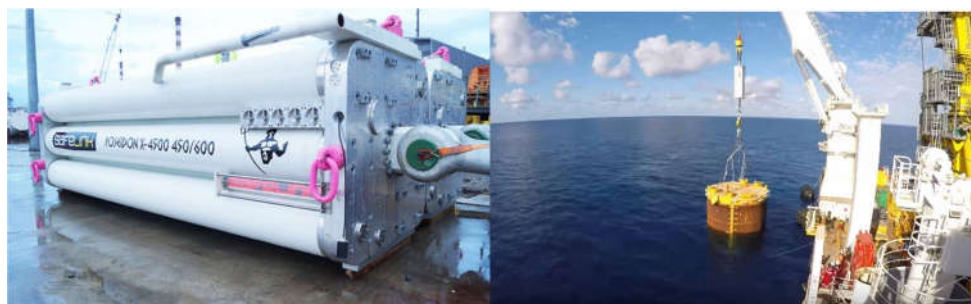
Hình 3. Thiết bị giảm chấn Safelink tấn lắp đặt vào cáp cần cẩu
