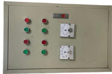
Hình 2.3. Mặt bên ngoài bộ thực hành PLC LOGO ! 230RCE SIEMENS
